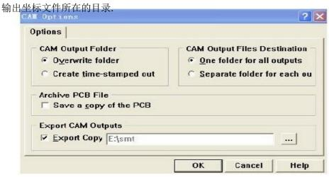
选择【Tools】/【Generate CAM Files】 在指定路径下生成坐标文件。
